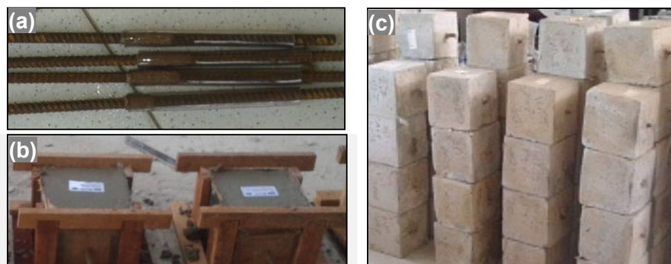
Figura 1 - Confecção dos corpos de prova, (a) uso da mangueira plástica na zona não aderente da barra; (b) moldagem e (c) estocagem em laboratório.
